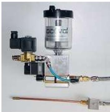
**La microlubrification**, appelée aussi **minimum quantity lubrication (MQL)** est utilisée pour introduire une **quantité précise d'un liquide** dans un processus.
